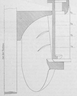
Fig. 2. Längsschnitt durch Lauf- und Leitrad einer Herkules-Turbine. 1:5.
