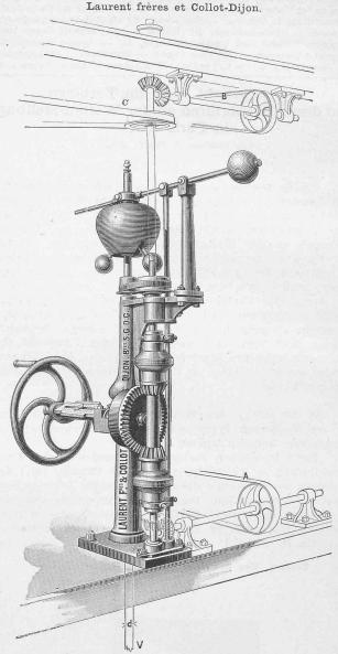
Fig. 5. Ansicht des Geschwindigkeitsregulators, System Laurent.
