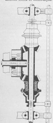
Fig. 6. Schema des Kehrgetriebes zum Geschwindigkeitsregulator.
