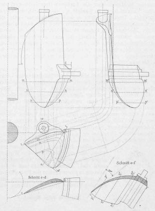
Fig. 1. Schaufelplan einer Herkules-Turbine. - 1:5.
