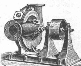
zum Fördern von schmutzigem und feste Bestandteile enthaltendem Wasser. Steine etc. zur Grösse von ein Drittel des Saugrohr - Durchmessers gehen durch dieselbe hindurch, ohne sich festklemmen zu können.
