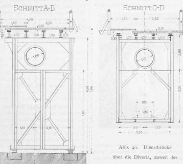
Maschinenhauses. — Querschnitte. Masstab I: 100.
