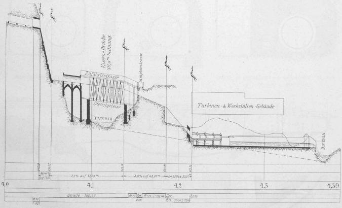
Abb. 37. Längenprosil der Druckleitung vom Stollenausgang bis zum Maschinenhaus. Masstab für die Längen 1:2000, für die Höhen 1:400.
