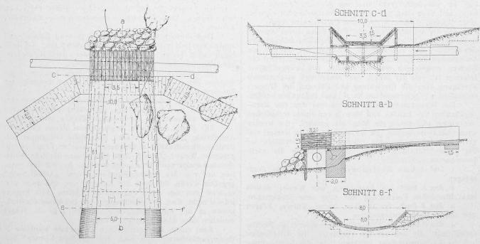
Abb. 33. Wasserkraftanlage der Südseite. — Ueberführung des Riale Rovale über die Druckleitung.
