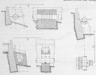
Abb. 32. Charakteristische Querprofile der Druckleitung. Masstab 1:200.
