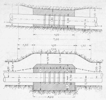
86,48% of Abb. 34. Wasserkraftanlage. — Druckleitung und Trinkwasserleitung (-+-+). 40,0 m Lichtweite, 3,00 m (Abb. 37 u. 38) ist sie durch Verankerung im Stollen. Längsschnitt und Grundriss 1:100. Abstand der Tragwände und
