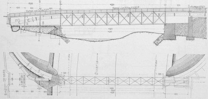
Abb. 39. Dienstbrücke über die Diveria unweit des Maschinenhauses. — Längsschnitt und Grundriss. — Masstab 1:400.
