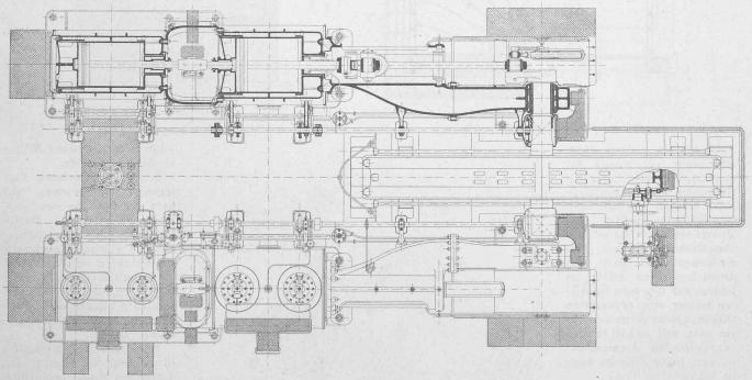
Abb. 2. Grundriss. - Schnitt durch die Mitteldruckseite und Ansicht der Hochdruckseite. Masstab 1:100.
