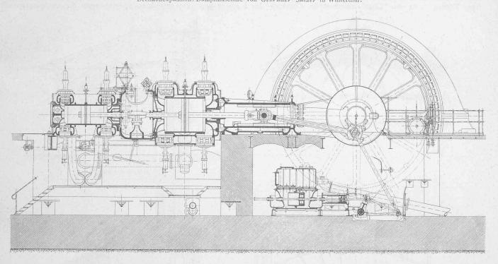
Abb. 1. Längsschnitt durch die Hochdruckseite. - Masstab 1:100.
