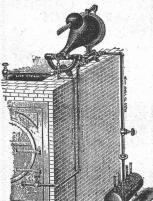
sammelt die Condenswasser und führt dieselben selbstthätig, heiss in den Kessel zurück.
