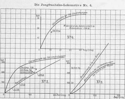
Fig. 7. Diagramme für den Drehstrom-Motor.
