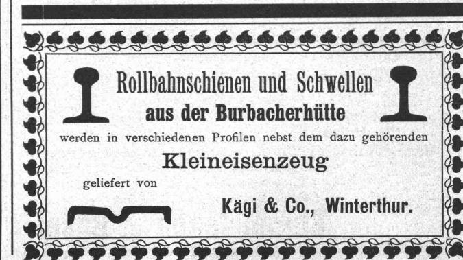
Rollbahnschienen und Schwellen
