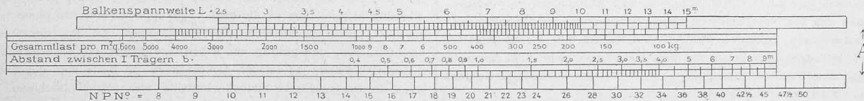
Auf unserer Abbildung ist der bewegliche Schieber A in einer Lage dargestellt worden, die unter anderen dasjenige I-Träger-Profil angibt, welches für eine Gebäude-Decke mit 6 m Spannweite, 500 kg Gesamt-Last per m<sup>2</sup> und 0,90 m Abstand zwischen zwei Trägern (oder Breite der Belastungsfläche eines Trägers) notwendig ist.
