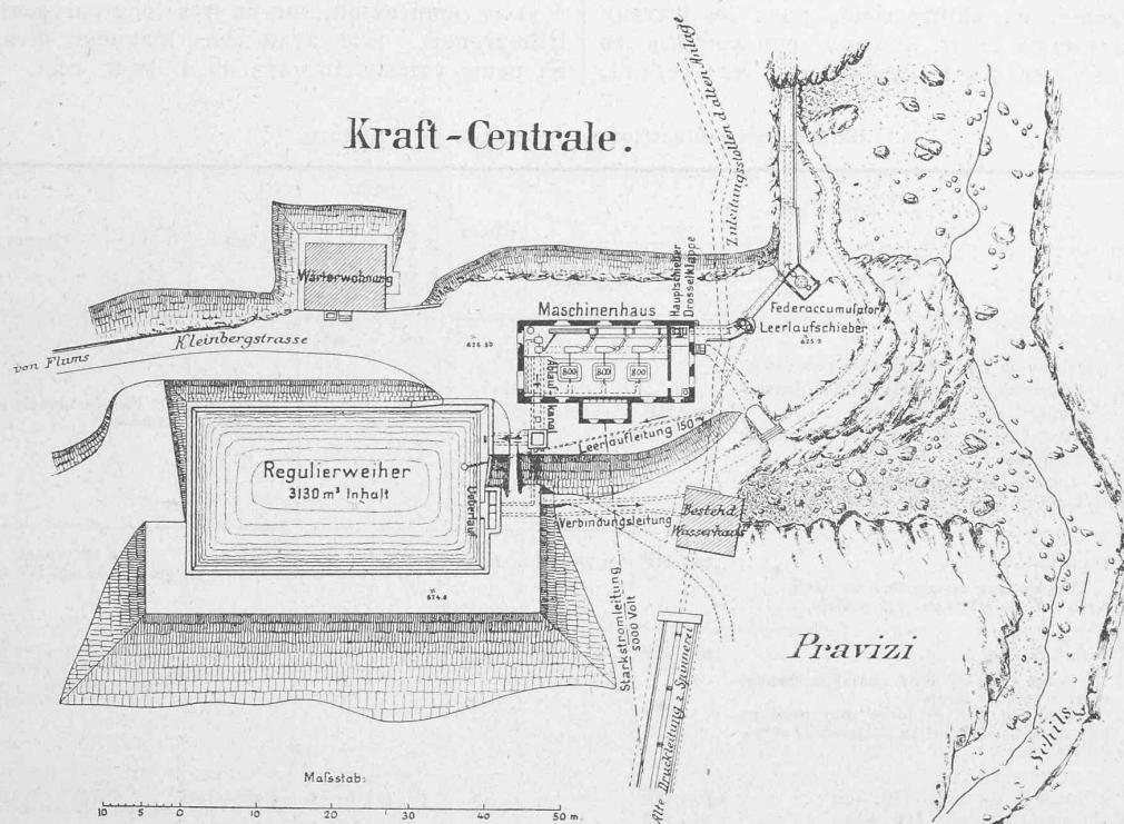
Abb. 24. Lageplan der Kraft-Centrale. — Maßstab 1:1000.
