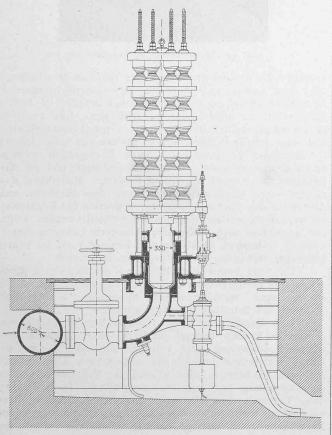
Abb. 20. Feder-Accumulator. Masstab .1:50.
