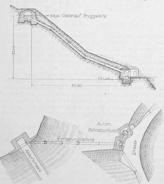
Abb. 21. Entlastungsleitung mit Ueberfall und automatischem Rohrabschluss. Masstab 1:600.
