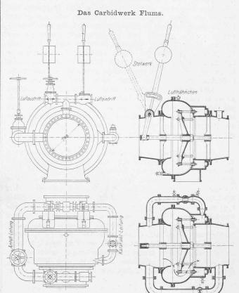
Abb. 22. Automatischer Rohrabschluss. — Masstab I:50.
