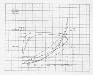
Abb. 4. Dreiphasenstrom-Motor von 350 P. S. Typ. 3071, 6000 Volt, 370 Umdrehungen, 50 Perioden.
