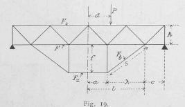
abstand von 2,00 m. Die Tragwände sind Parallelträger mit vierfachem Strebenzug. Alle 2 m sind die beiden Tragwände durch Querriegel und Andreaskreuze untereinander verbunden. Die Schwellen liegen auch hier direkt auf den Tragwänden,
