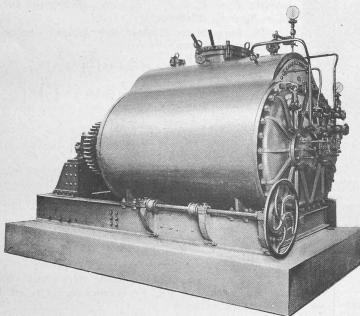
Fig. 3. Mischmaschine, System Schwarz.
