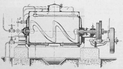
Fig. 4. Mischmaschine, System Schwarz. — Längsschnitt.
