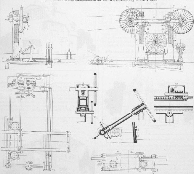
Abb. 12. Horizontale Bandsäge von *Theodor Bell & Cie.*, A.-G. in Kriens.
