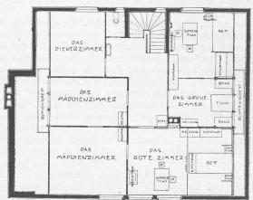
Abb. 10 d. Haus Olbrich. — Grundriss der Dienerschaftsräume. Masstab 1:175.
