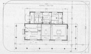
Abb. 8. Birsigthalbahn-Station. — Grundriss 1:300.
