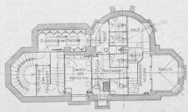
Abb. 3. Grundriss vom Kellergeschoss 1:200.
