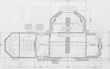
Abb. 5. Tramstations-Gebäude auf dem Barfüsserplatz in Basel. Grundriss vom Erdgeschoss 1:170.
