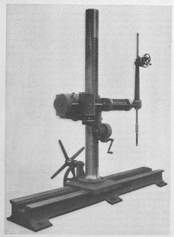
Abb. 4. Universal-Bohr- und Gewindeschneidmaschine mit elektr. Antrieb.
