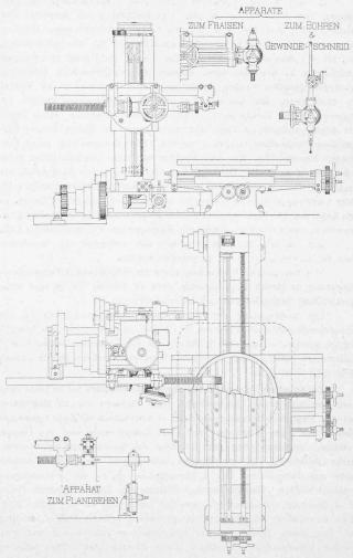
Abb. 3. Universal-Fräsmaschine. — Masstab 1:50.
