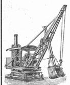
zum Abgraben von Erdmassen und Verladen derselben in Wagen, auch als **Krahn** zum Heben von Lasten und als **Greifbagger** verwendbar.
