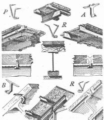
A & B in zwei Grössen verbinden stumpfe Bretter direkt mit I-Eisen.
