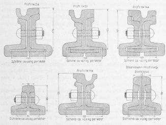
Fusslaschenprofile der «Phönixwerke» für Rillenschienen und Vignolschienen. — 1:7.
