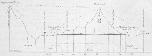
Abb. 9. Albulatunnel. - Längenprofil der Achsabsteckung über den Berg. Masstab 1:75000 für die Längen, 1:30000 für die Höhen.
