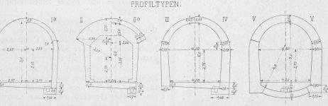
Abb. 10. Normalquerprofil des Albulatunnels. Masstab 1:200.
