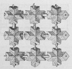
Fig. 1. Drahtziegel von Stauss & Ruff.
