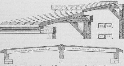
Fig. 8. Wasserdichte Terrassenbalken — nach unten offen oder geschlossen.
