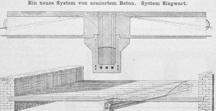
Fig. 6. Hohle Unterzüge für Spannweiten bis zu 8 m, mit nachträglicher Verstärkung.
