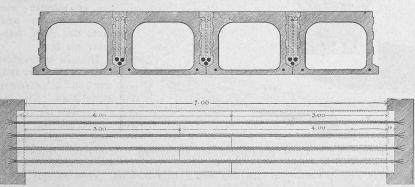
Fig. 4. Konstruktion für grosse Spannweiten bis zu 8 m.
