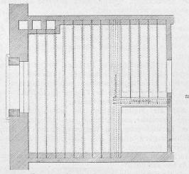
Fig. 3. Balkenlage mit Auswechslung. w Wechselbalken;  $w^1$  ausgewechselter Balken.
