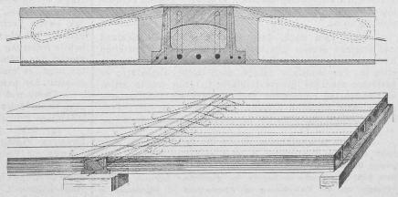
Fig. 5. Teilungsbalken für Spannweiten bis zu 7 m.
