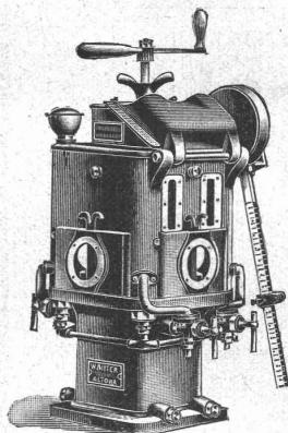
**Keine zerstörenden Einflüsse** der Bewegungsmechanismen durch Staub, Schmutz etc., weil **mit vollständigem Schutzmantel** und **Getriebeschutz** versehen.
