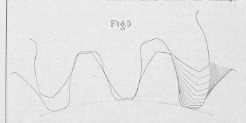
Verhältnis zu setzen und auf den Durchmesser des Arbeitsstückes richtig anzustellen. Nachdem das Werkzeug auf die genaue Tiefe eingeführt ist, erfolgt die weitere Bearbeitung, die Fertigstellung des Rades ohne weiteres Zuthun ganz selbstthätig, auf Fellows' Maschine.
