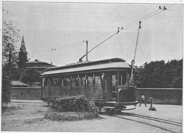
Fig. 1. Duplex-Wagen mit Schmierapparat für den Fahrdraht.
