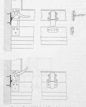
Fig. 3. Feststell-Hebel und Kuppelungsvorrichtung der Wagenfenster.
