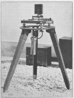
Fig. 11. Absteckungs-Stativ mit Schlitten, Acetylenlampe und angehängtem Generator.
