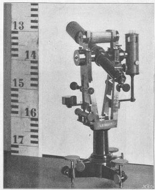
Fig. 10. Instrument für Absteckungen im Innern des Tunnels.
