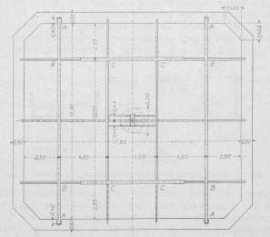
Fig. 2. Grundriss des Bodens unter der Kuppel. — Masstab 1:250.
