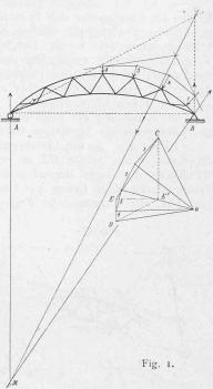
die letzte Seite des Seileckes bis F auf der Auflagerdruckrichtung von A, so kann mit FB die Schlusslinie gezogen werden. Da Gleichgewicht besteht, so liegen die Endpunkte der Kräfte auf den entsprechenden Polstrahlen des Kräfteecks. Zieht man daher durch O eine Parallele zu FB und durch D eine Parallele zur Auflagerdruckrichtung von A, so werden die Reaktionen: A = DE und, da das Kräfteeck geschlossen sein muss, B = EC.
