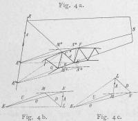
Richtung der Diagonale bis zum Schnittpunkt mit A in R und zerlege A in die Richtung der Strebe und nach dem Schnittpunkte S der entsprechenden Gurtstäbe", sei hier nicht anwendbar, da dieser Punkt vom Blatte fällt. Für diesen Fall hat bereits der alte Meister die indirekte Lösung gegeben, indem er einen
