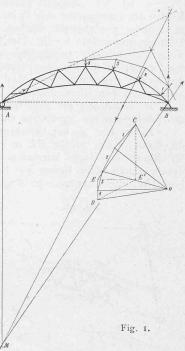
die letzte Seite des Seileckes bis F auf der Auflagerdruckrichtung von A, so kann mit FB die Schlusslinie gezogen werden. Da Gleichgewicht besteht, so liegen die Endpunkte der Kräfte auf den entsprechenden Polstrahlen des Kräfteecks. Zieht man daher durch O eine Parallele zu FB und durch D eine Parallele zur Auflagerdruckrichtung von A, so werden die Reaktionen: A = DE und, da das Kräfteeck geschlossen sein muss, B = EC.
