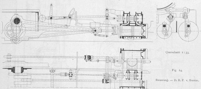
Längsschnitt und Grundriss der Steuerung. — Masstab 1:33.
