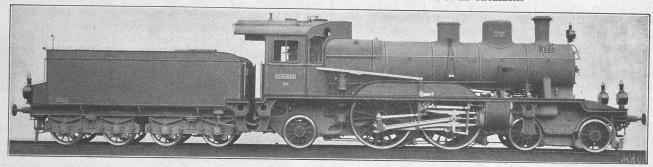
Fig. 15. Viercylinder-Verbund-Schnellzugslokomotive der sächsischen Staatsbahn.
