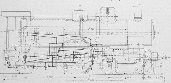
Fig. 6. Viercylinder-Verbund-Schnellzugslokomotive. -- Längsschnitt 1:60.
