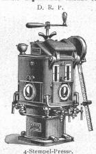
Keine zerstörenden Einflüsse der Bewegungsmechanismen durch Staub, Schmutz etc., weil mit vollständigem Schutzmantel und Getriebschutz versehen.
