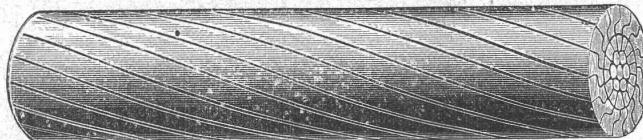
für Luftbahnenlaufseile, Trajekt- und Brückenseile, Bergbahnenseile.
