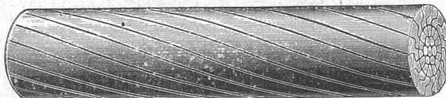
für Luftbahlaufseile, Trajekt- und Brückenseile, Bergbahnsseile.
