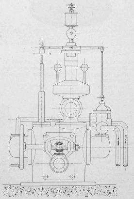
Fig. 44. Schema des Regulators mit hydraulischem Hochdruck-Servomotor.
