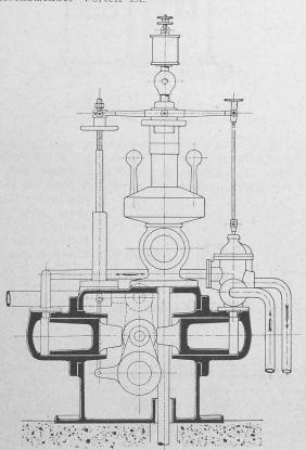
Fig. 43. Schema des Regulators mit hydraulischem Hochdruck-Servomotor. Schnitt.
