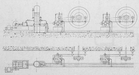
Fig. 46. Gesamtdisposition einer Regulierungsanlage von Escher Wyss & Cie.
