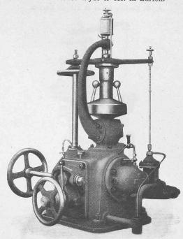
Fig. 45. Regulator mit hydraulischem Hochdruck-Servomotor.
