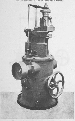
Fig. 49. Hydromechanischer Universal-Regulator.
