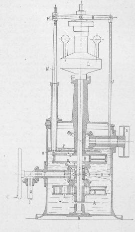
Fig. 47. Schematischer Querschnitt des Hydromechanischen Universal-Regulators.
