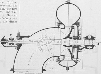
Fig. 38. Francisturbine mit Zodelregulierung. Masstab 1:30.
