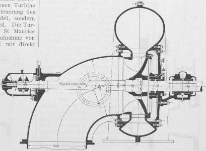
Fig. 38. Francisturbine mit Zodelregulierung. Masstab 1:30.
