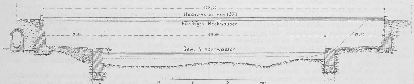
Fig. 2. Von der Unternehmung vorgeschlagenes Normalprofil. 1:600.
