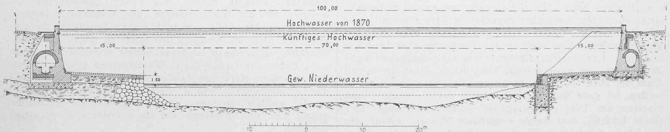
Fig. 1. Ursprünglich von der Kommission vorgeschlagenes Normalprofil. 1:600.
