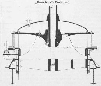
Fig. 25. 28 P.S. Francis-Turbine, für die Schiffschleuse am Franzenskanal. 1:25.
