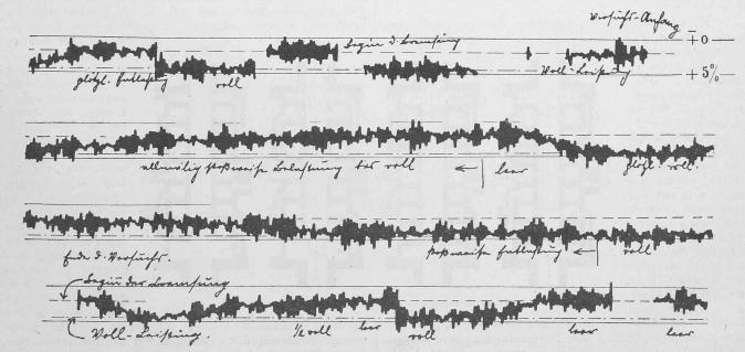
Fig. 28. Tachographen-Diagramm eines Widerstandsregulators Rüsch-Sendtner Nr. 3.
