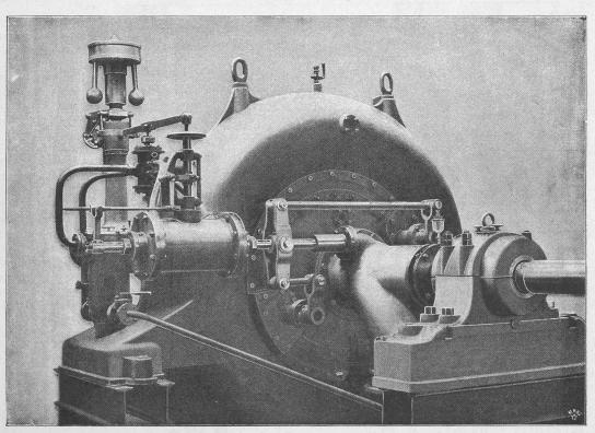
Fig. 19. 630 P. S. Francis-Turbine für das Elektricitätswerk Jajce (Bosnien).
