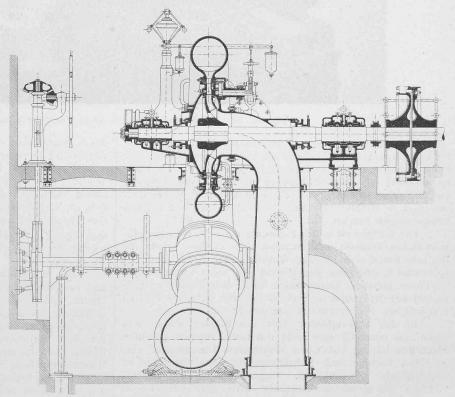
Fig. 21. 1000 P. S. Francis-Turbine (an der Ausstellung). Masstab 1:50.
