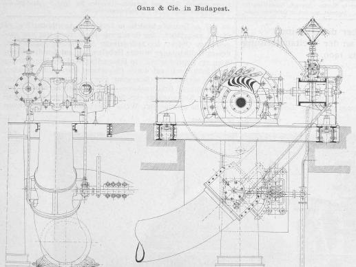
Fig. 20. 1000 P.S. Francis-Turbine (an der Ausstellung). Masstab 1:50.
