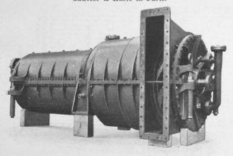
Fig. 44. 1200 P. S. Dampfturbine, System Rateau,
