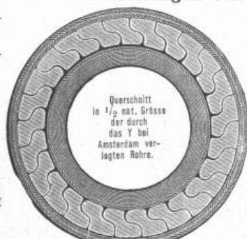
erscheint, im besonderen, wenn es sich darum handelt, gegen inneren und äusseren Druck widerstandsfähige Rohrleitungen durch Flüsse, Kanäle, Seen, Gebirge, Tunnels etc. zu verlegen.
