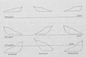
Fig. 15. Dampfdiagramme zur dreistufigen Maschine von E. Merts in Basel.
