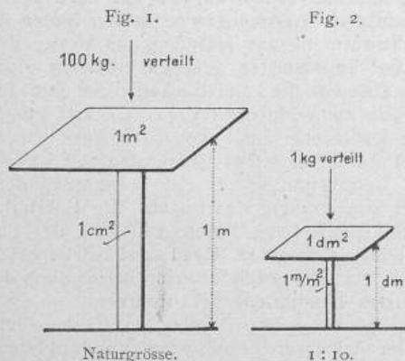
*Zufällige Last.* Für die folgenden Ableitungen ist vorausgesetzt, dass das Modell in allen Dimensionen der Naturausführung geometrisch ähnlich ist und aus gleichem Material besteht wie diese.
