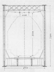
Fig. 18. Leitungs-Anordnung auf der Aarebrücke bei Thun. 1:125.
