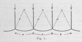
Bezeichnen wir mit ; die, durch die getragenen Lasten veranlasste, elastische Verdrückung des Bogens, gemessen in der Richtung des Halbmessers, so ist die senkrecht zum Bogen stehende Belastung u auf die Einheit  $=\psi$  z zu setzen, wenn \u03c4 den Widerstand des Untergrundes für die Flächeneinheit bei der Einsenkungstiefe = 1 bedeutet und ein Abschnitt der Bauanlage von der Tiefe 1, senkrecht zur Bildebene, der Betrachtung zu Grunde gelegt wird.
