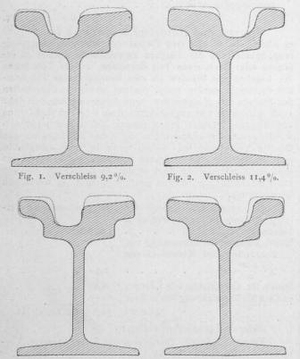
Fig. 3. Verschleiss 20,3% Fig. 4. Verschleiss 13,3% (Stoss in einer Kurve). Masstab 1:3. (20 cm vom Stossende).
