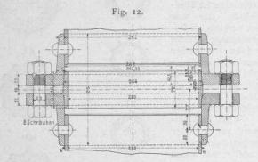
Flanschenverbindung der Dampfleitungen, 1:6.
