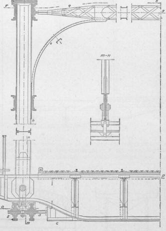
schiedenheit in der Durchbiegung der beiden Hauptträger und eine rhombische Verschiebung des ganzen Brücken-Querschnittes tritt hier gar nicht oder doch nur selten ein. Deshalb können in diesem Falle die oberen Quer-
