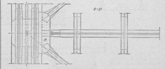
riegel (q) steifer ausgebildet werden, wenn man gleichzeitig darauf bedacht ist, die Hängestangen h gegen Biegen schwach zu machen, wie dies bei der Trarbacher Brücke (Fig. 23) der Fall ist.
