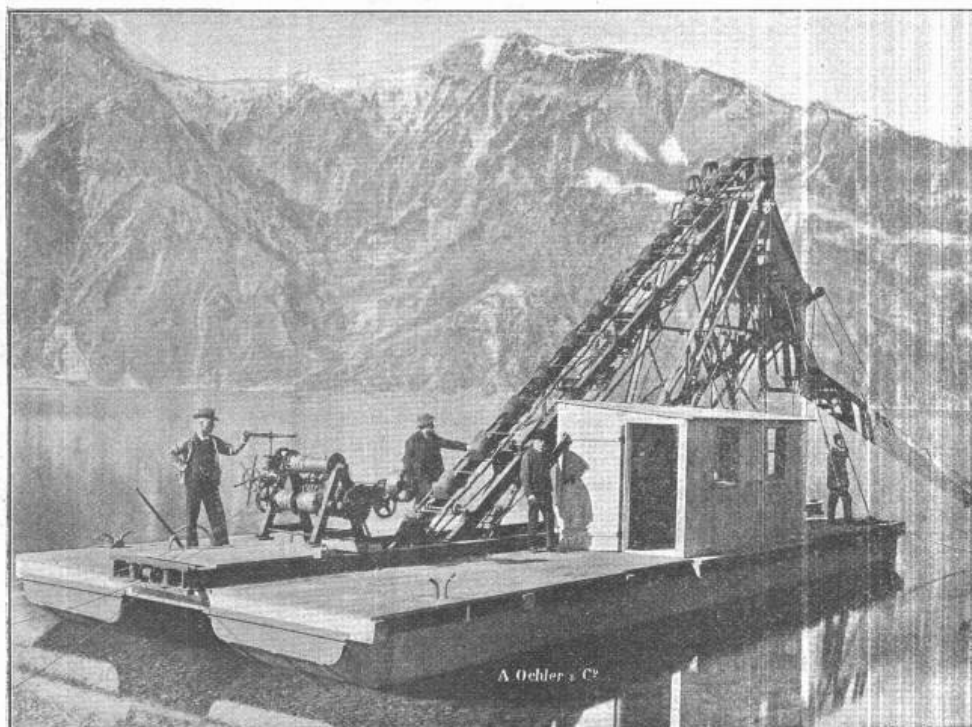
Maschine in Flüelen, mit verstellbarer Sortiereinrichtung. Leistung 150 m 3
