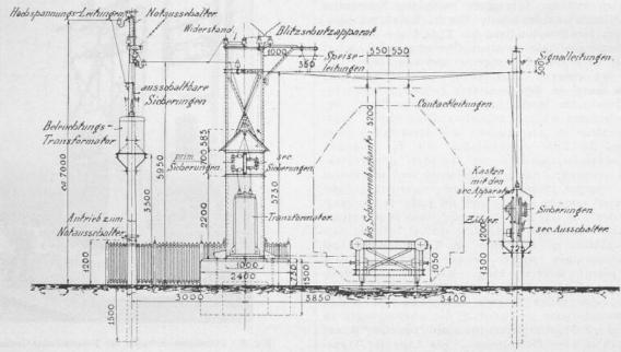
Fig. 10. Normale Transformatorenstation mit Anordnung der Leitungen. 1:100.
