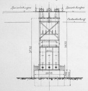
Fig. 12. Transformatorenturm von der Bahn gesehen. 1:100.
