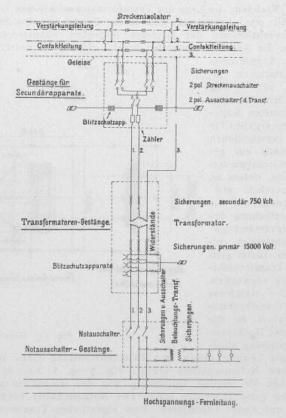
Fig. 9. Schema des Anschlusses der Transformatoren-Stationen.
